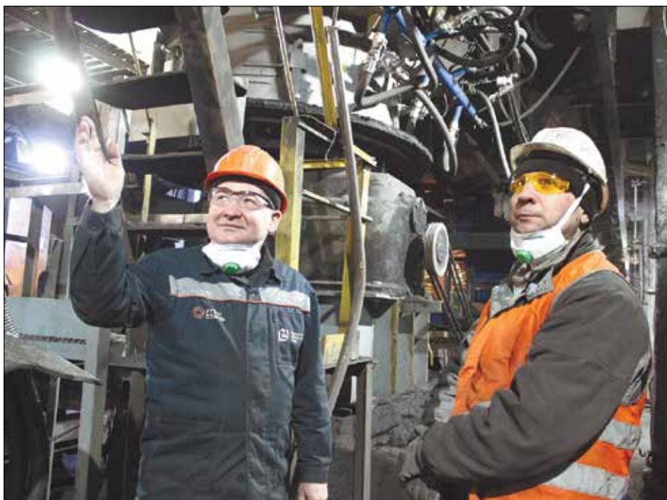
■ На смесительный бункер установили пневматическую систему: форсунки, шланги, трубы.
