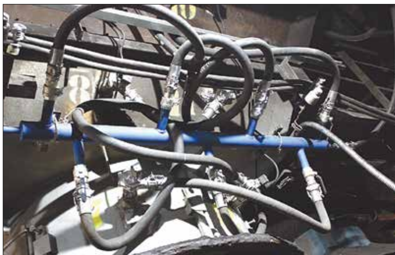
■ На смесительный бункер установили пневматическую систему: форсунки, шланги, трубы.
