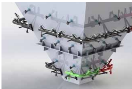
Рис. 1. Макет системы пульсирующих форсунок для бункера гипсосодержащих добавок на российском предприятии (цементном заводе 1)
